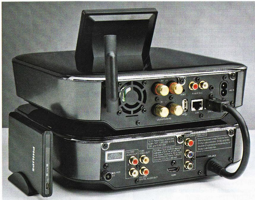
Le due unità sfoggiano morsetti e connettori dorati dall'aspetto rassicurante. Si nota l'antenna per le reti wireless e, sulla sinistra, il compatto hard disk rimovibile che permette di immagazzinare parecchia musica senza dover spostare l'impianto vicino al PC.
